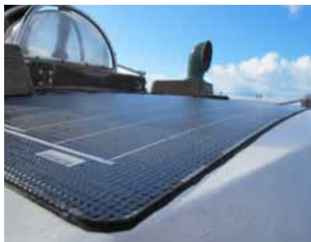
Flexibla solpaneler lämpar sig särskilt bra för lätt välvda ytor.
