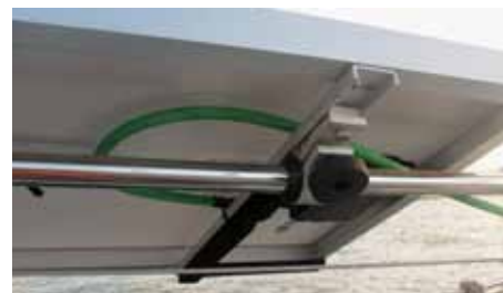
Mary af Rövarhamn försågs med 25 mm tjockt rostfritt rör mellan sista mantågsstötten och pushpiten på vardera sidan av båten. Panelerna fästes sedan vid röret med vridbara Noa-fästen.
