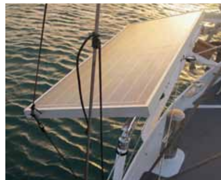
Solpanelerna är stabiliserade med linor, uppåt och nedåt. Linorna är knutna till vantet med en stoppstek så de lätt kan förskjutras upp och ner.
