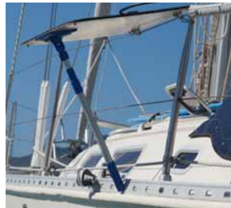
En teleskopisk båtshake eller svabb kan förvandlas till ett bra stödben.
