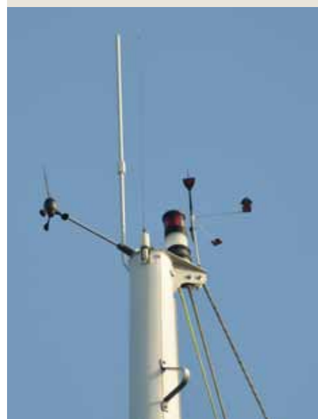
Många väljer att montera en åskledare (t.v.) högst upp i masttoppen, i hopp om att den ska fånga in en eventuell blixurladdning och leda ner blixtnedslaget till vattnet med minsta möjliga skada på båt och besättning. Medan andra satsar på en tingest som på engelska kallas "lightning dissipator" (t.h.), och påstås kunna avvärja blixtnedslag helt och hållet. Ingen av dem ger någon garanti, men den förstnämnda är mer beprövad.
