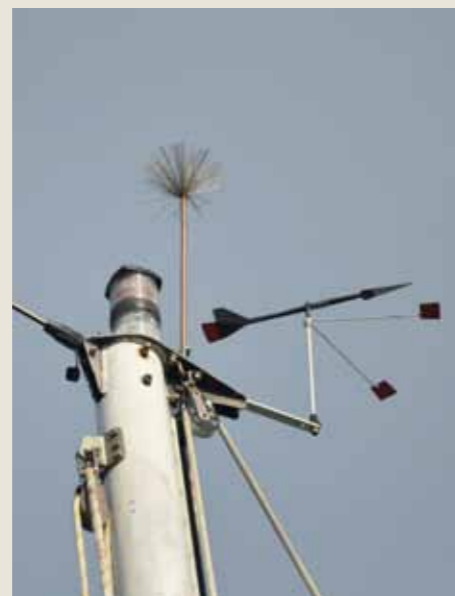
Många väljer att montera en åskledare (t.v.) högst upp i masttoppen, i hopp om att den ska fånga in en eventuell blixurladdning och leda ner blixtnedslaget till vattnet med minsta möjliga skada på båt och besättning. Medan andra satsar på en tingest som på engelska kallas "lightning dissipator" (t.h.), och påstås kunna avvärja blixtnedslag helt och hållet. Ingen av dem ger någon garanti, men den förstnämnda är mer beprövad.
